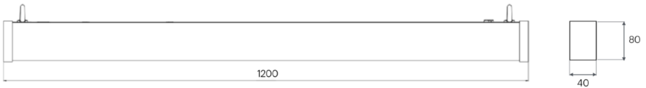
Рис. 1. Габаритные размеры светильника
